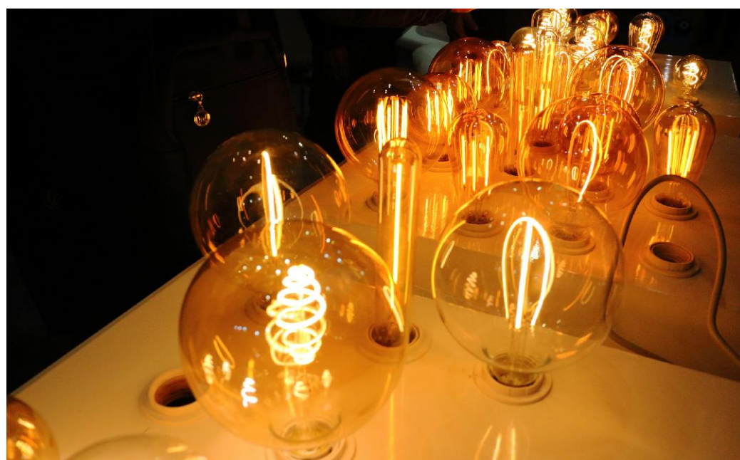
图为邹军副教授领衔研发的“柔性LED灯丝球泡灯制备技术”
